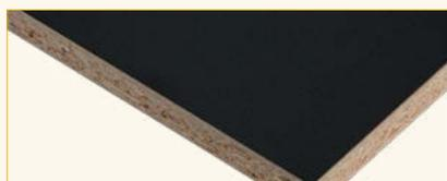
**Les Panneaux de particules surfacés mélaminés (PPSM)** sont des panneaux de particules recouverts sur les deux faces par un ou plusieurs papiers décoratifs imprégnés de résine mélamine-formol. La résine est poly condensée à chaud et sous pression, ce qui lui confère des qualités importantes de dureté et de résistance. On peut ainsi obtenir des panneaux blancs ou de couleur, avec un décor fantaisie ou bois.
