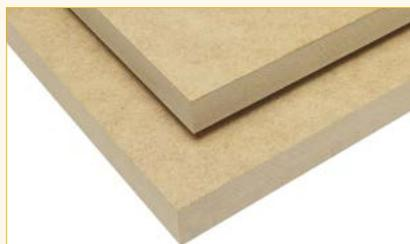
**Les panneaux de fibres** sont composés à partir de l'élément de base du bois, la fibre lignocellulosique et possèdent, pour certains, une quasi-isotropie dans toutes les directions du plan. Les panneaux de fibres sont définis par la norme européenne NF EN 316 et leurs caractéristiques sont précisées par les normes européennes NF EN 622-1 à 622-5.
